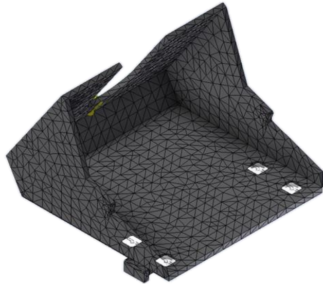
Figure 7: Custom Nexsteer EPS Mount. (Cameron Chiamonte, 2023)
