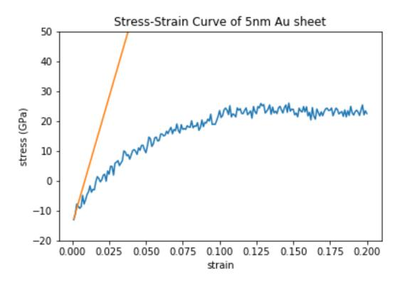
5nm Tensile Test; Y=1696.27
