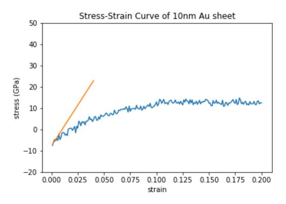
10nm Tensile Test; Y=763.29
