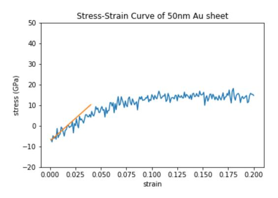
50nm Tensile Test; Y=439.58
