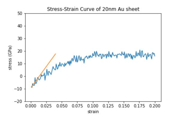
20nm Tensile Test; Y=675.48
