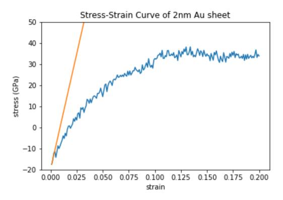
2nm Tensile Test; Y=2174.98
