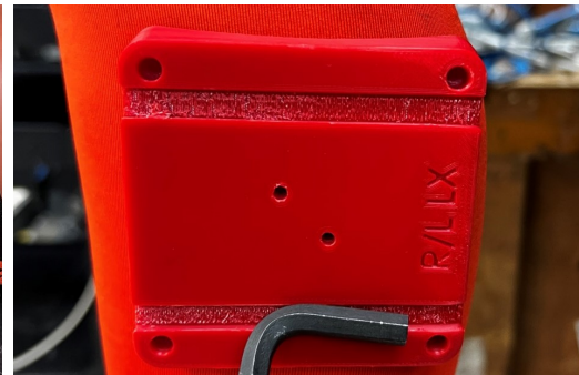
(d) Sensor and marker mount for the lower leg.
