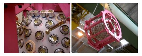
Figure 4.10: 240-Module Pure CsI calorimeter
